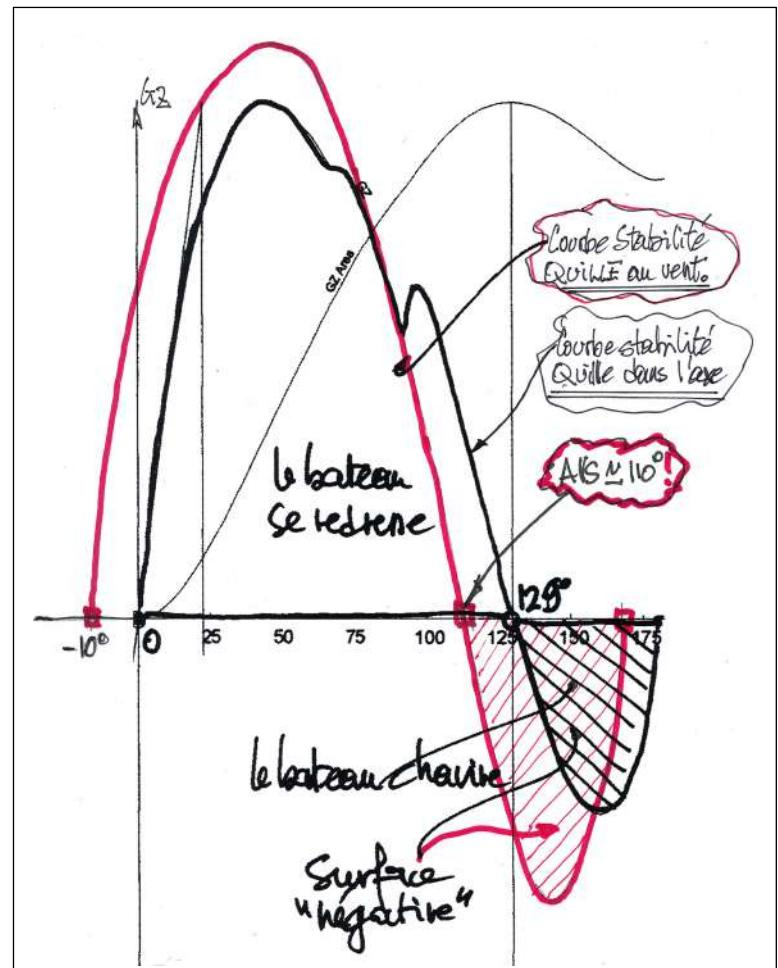
diminution de l'Avs », c'est-à-dire sa propension à résister au chavirage, passe alors au second plan. Le paradoxe est d'ailleurs double, car à l'inverse si on angule la quille sous le vent (et que l'on remplit aussi les ballasts latéraux sous le vent), on constate que l'angle de chavirage Avs « recule » vers 150°.
