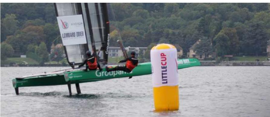
C'est un autre monde, le catamaran vole sur un foil en L (coque sous le vent), sa stabilité horizontale en vol étant gérée par les plans horizontaux régulateurs (PHR) implantés en extrémité des safrans. Le barreur agit sur ces PHR comme le fait le barreur sur un Moth Foiler. L'incidence du foil et l'assiette transversale étant géré pas l'équipier.
