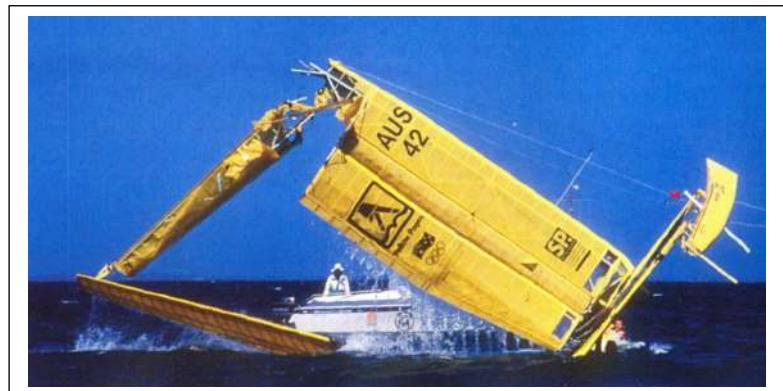
Toutefois l'utilisation d'ailes rigides construites sur la base d'architectures en CP et d'un revêtement en toile ne permet pas d'augmenter l'envergure de l'aile (environ 9.90m) par rapport à une voilure classique GV+Foc (10m).
