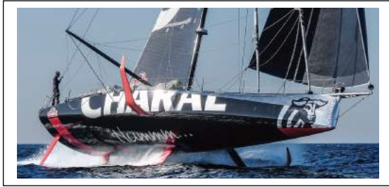
Le safran sous le vent est visible (tableau AR décollé).
