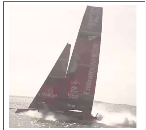
+ 26 s L'incidence du Foil augmente... et Décrochage... chute immédiate + 40 s
