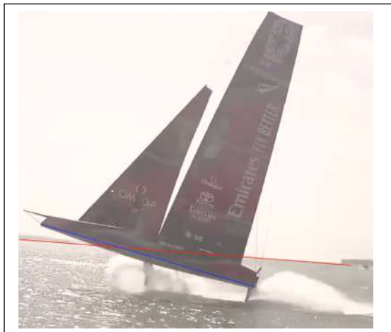
+ 26 s L'incidence du Foil augmente... et Décrochage... chute immédiate + 40 s
