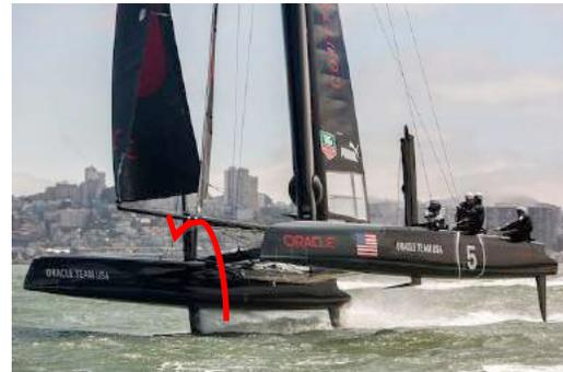
Sur le catamaran (AC72), ce sont les foils sous le vent qui servent de pivot au couple de chavirement. Le centre de gravité de l'AC72 est sensiblement entre le pied de mat et la coque au vent. La masse de l'équipage déplace un peu le centre de gravité de la plateforme et du gréement qui est pas défini dans le plan de symétrie du catamaran.
