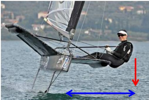
Sur le Moth on comprend très bien que le déport de barreur, donc de sa masse (flèche rouge), et de la distance sensiblement horizontale (flèche bleue) entre sa position et le centre de portance du foil, génère le couple qui empêche de chavirer.
