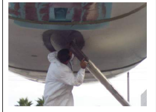
Installation d'une quille pendulaire sur un ancien bateau (modification).
