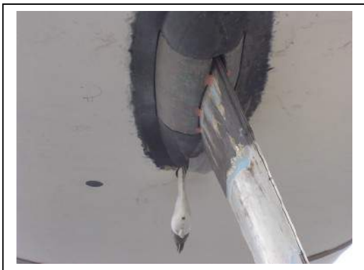
Installation d'une quille pendulaire sur un ancien bateau (modification).
