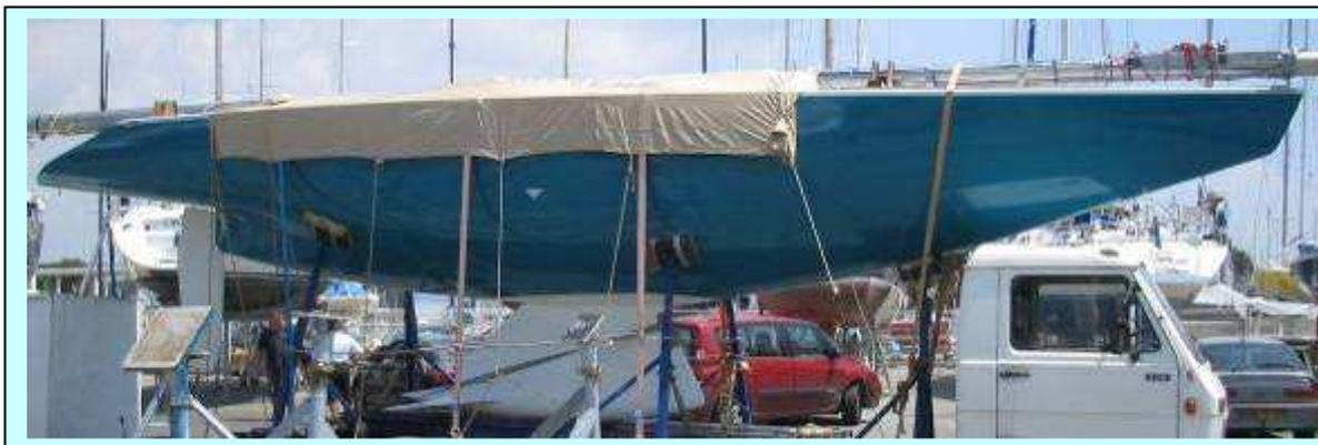
*6M JI moderne et ancien relevant de la même formule de jauge internationale. Les nouveaux matériaux permettront aux architectes d'imaginer d'autres formes de carènes. Les gains de vitesse apparaissent très faibles, car les déplacements imposés restent toujours élevés.*
